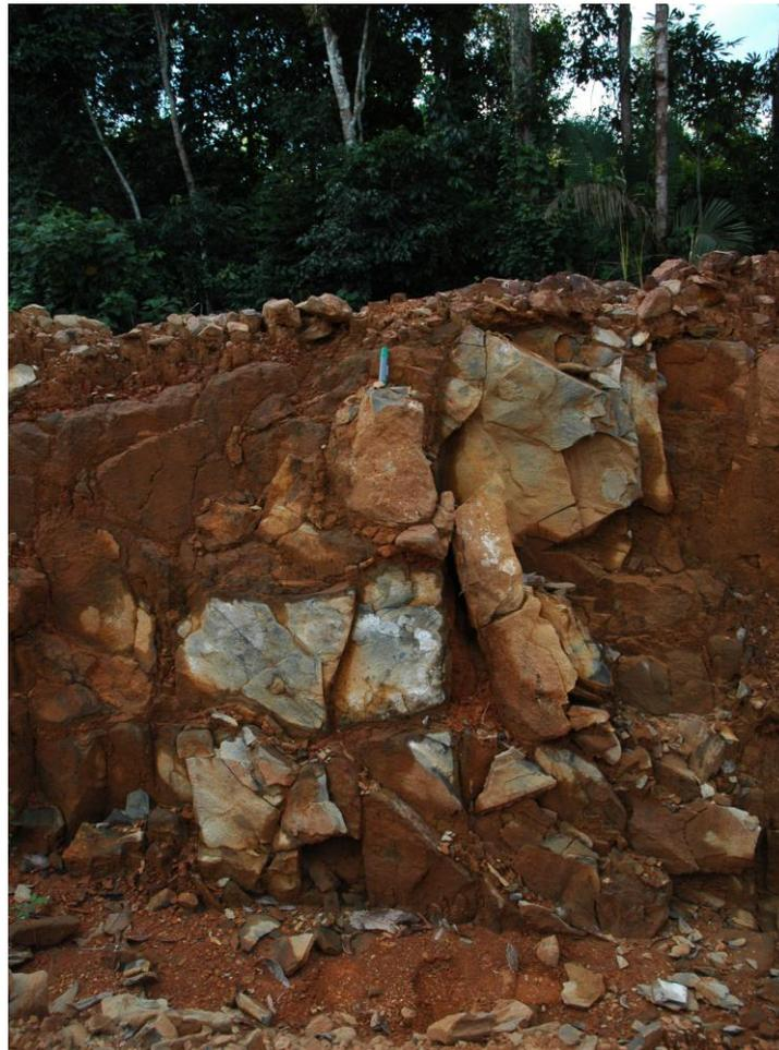
**Fotografia 7.** Afloramento de microgranito. Local de área de empréstimo para pavimentação de estradas (ponto MCH-15). Autora: Fabiana Barbosa Gomes, junho de 2008.
